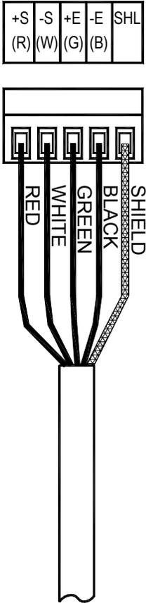
**Figure 1.10: Sensor Wiring**
